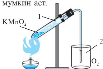
Рас. 27. Бо усули фишурда баровардани ҳаво чамъ кардани оксиген: 1) шишапахта; 2) ҳаво.
